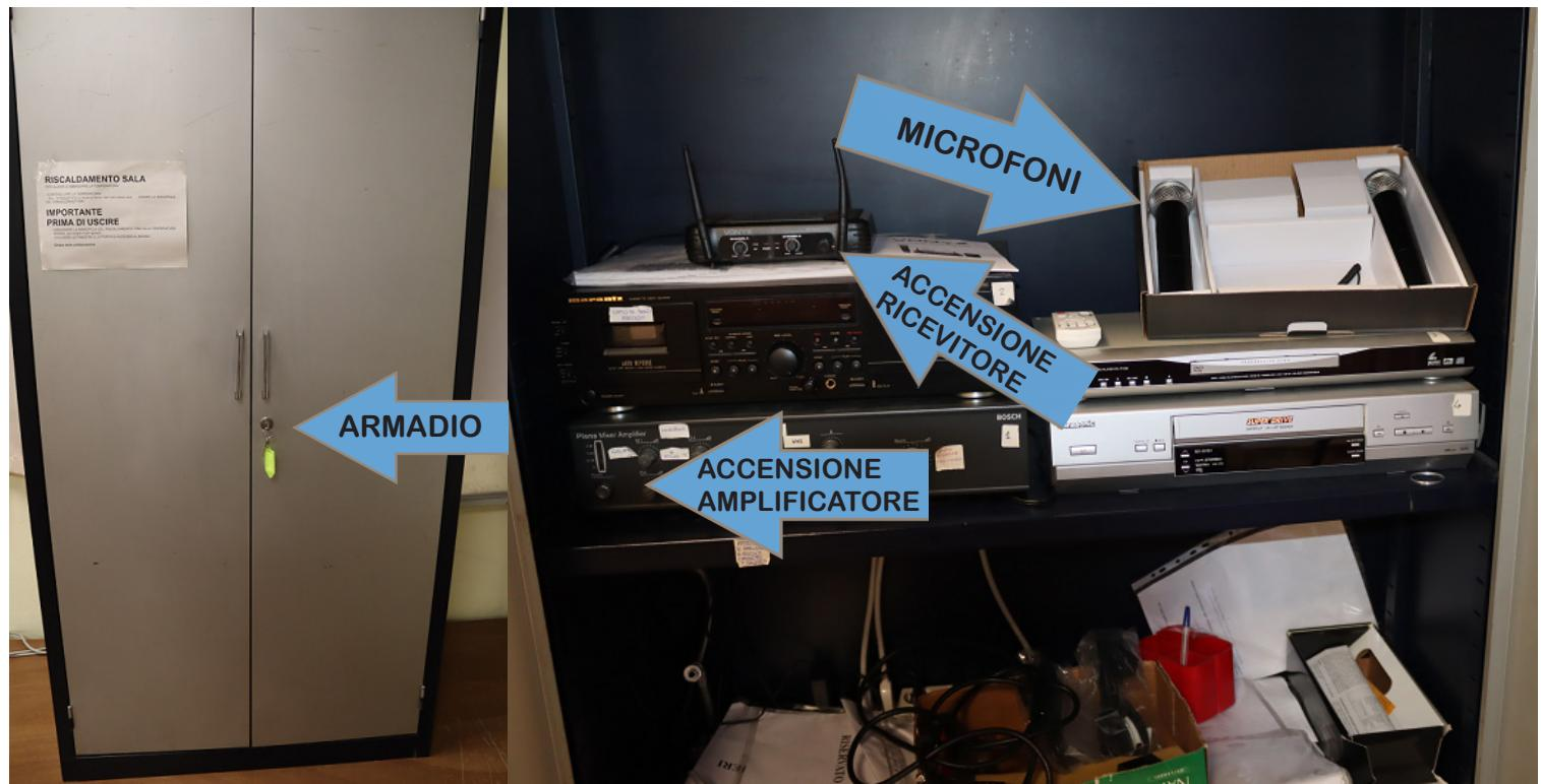
I microfoni wireless sono collegati a ricevitore e amplificatore, sempre nell'armadio (vedi foto). Accendere ricevitore wireless e amplificatore dai tasti sul fronte degli apparecchi (vedi foto).
