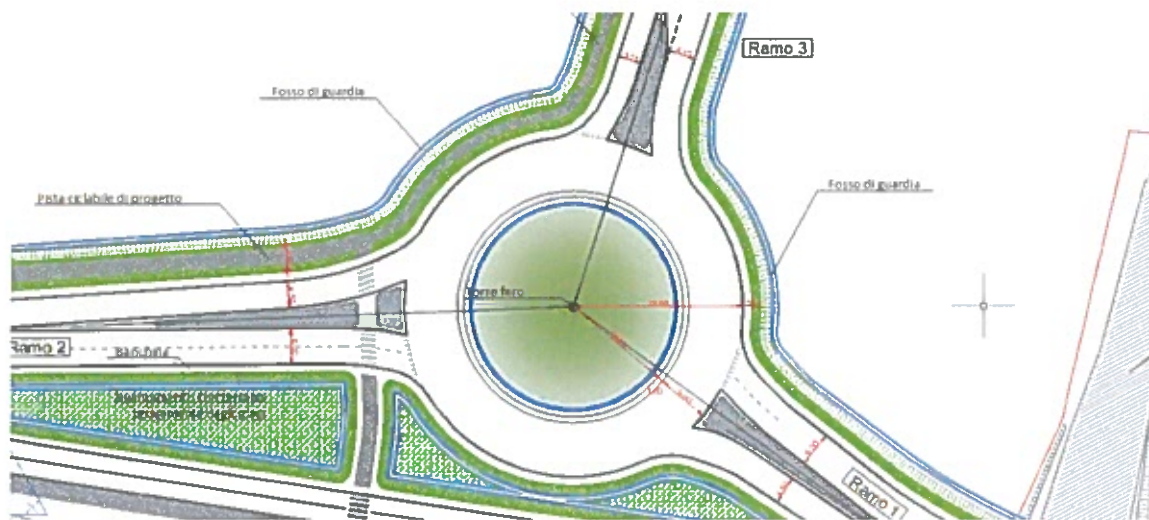
Fig. 6: Planimetria di progetto: raggi della corona
