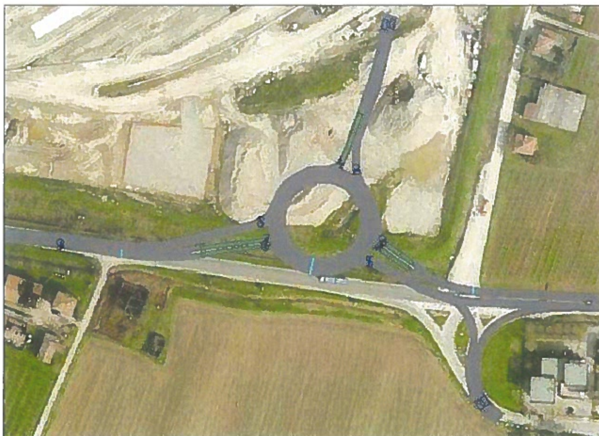
Schema della rete per la simulazione, zone di frenatura e sezioni di rilievo di passaggi e velocità
