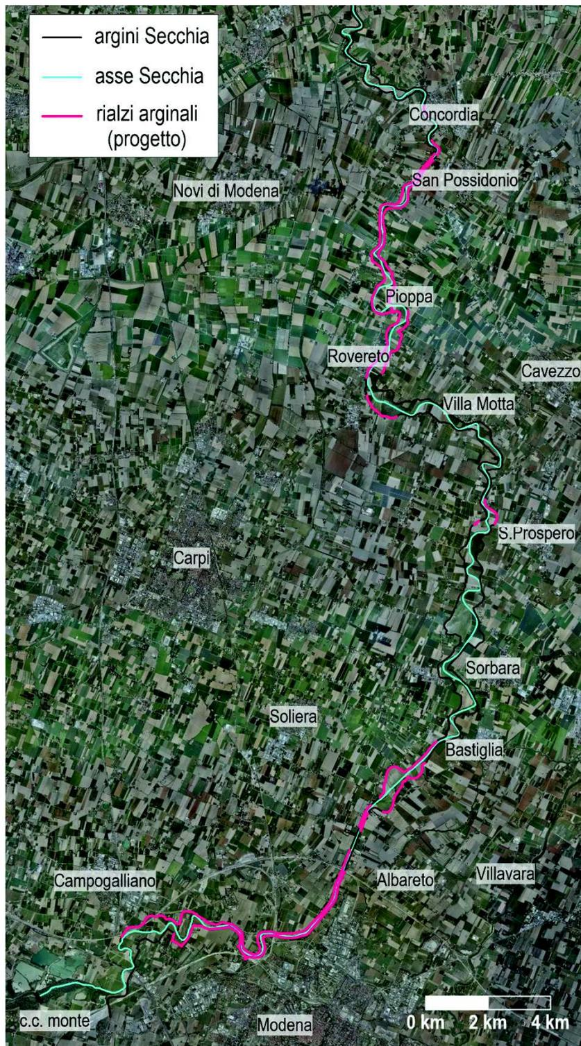
Figura 2-3 – Indicazione dei tratti di argine del fiume Secchia interessati dal progetto di rialzo (in magenta). Gli argini del tratto più vallivo, escluso dall'immagine, non prevedono da progetto alcun rialzo.
