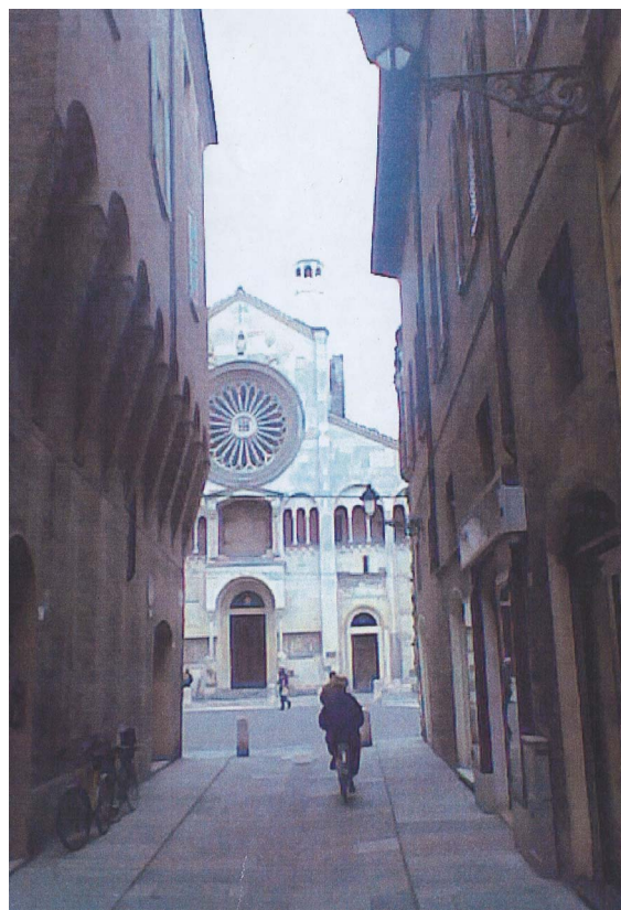
PARTICOLARE 2 – VIA S. EUFEMIA (RECENTEMENTE RISTRUTTURATA) - IL LASTRICATO E' IN LASTRE DI GNEISS
