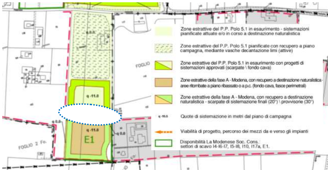
Figura 6: Estratto da tavola 2.2.h.1 del PC "Progetto – Planimetria di sistemazione morfologica"; evidenziato in blu il setto di separazione tra le cave Poggi ed E1, previsto nel PC, ma assente secondo la previsione del presente progetto
